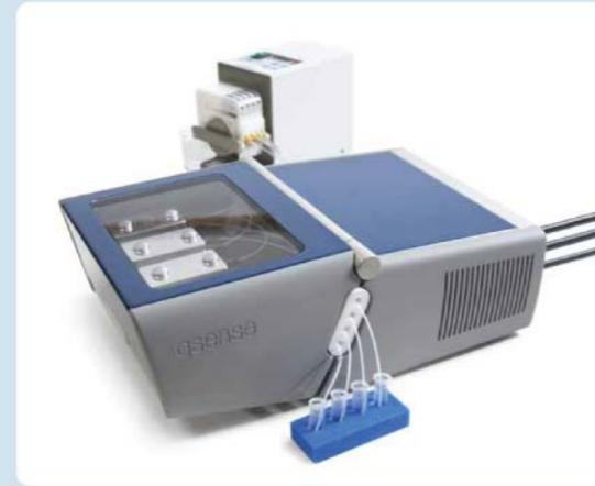
2. 加入样品进行原位检测，运行设置的实验进程，如样品A-缓冲溶液-样品B-缓冲溶液。
