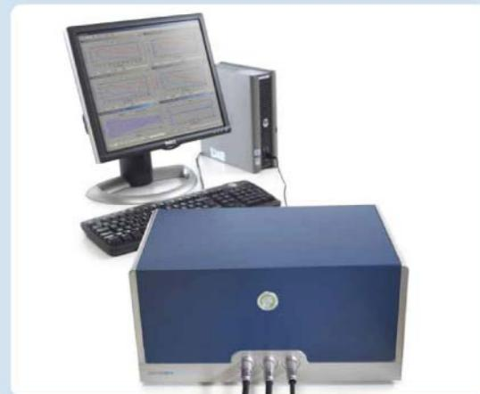
3. 屏幕上显示实时数据，频率变化反应了传感器表面发生质量变化，耗散因子的变化反应了吸附层粘弹性的改变。
